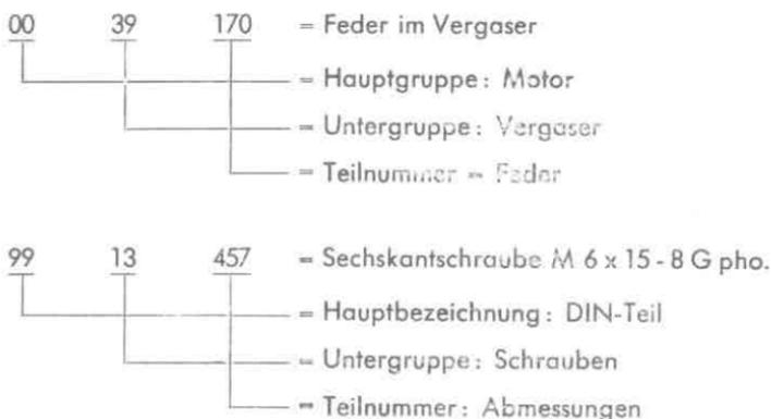
Ist die **Ersatzteilnummer** (Bestell-Nummer) eines Ersatzteiles zu suchen, so wird in der Bildtafel der Hauptgruppe die **Bild-Nummer** festgestellt und unter Zugrundelegung dieser Bild-Nummer im zugehörigen Text die Ersatzteil-Nummer ermittelt, wobei erforderlichenfalls auch die Fahrgestell-Nummer anzugeben ist.
