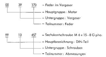
Ist die **Ersatzteilnummer** (Bestell-Nummer) eines Ersatzteiles zu suchen, so wird in der Bildtafel der Hauptgruppe die **Bild-Nummer** festgestell: und unter Zugrundelegung dieser Bild-Nummer im zugehörigen Text die Ersatzteil-Nummer ermittelt, wobei erforderlichenfalls auch die Fahrgestell-Nummer anzugeben ist.
