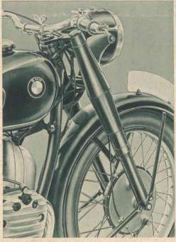
Ideale Vorderrad-Federung mit Olrückstofydämpfer durch die bewährte Teleskopgabel. Grofye Innenbackenbremsen. Untereinander auswechselbare Räder mit Steckachsen.
