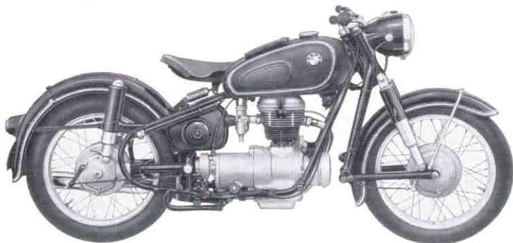
Leistungsstarker Einzylinder-Motor. Geräuschdämpfung durch große Ansaug- und Luftfilterkammer. Vierganggetriebe, Fußschaltung. Besonders weich wirkende Kupplung. Vorder- und Hinterradschwinge mit Feder-
