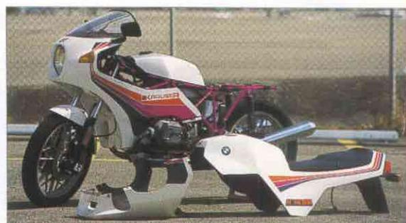
Le cadre treillis d'inspiration italienne est habillé d'un ensemble selle-faux-réservoir monocoque qui une fois retiré dévoile le véritable réservoir.
