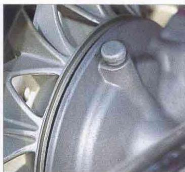
Le montage du bras oscillant élargi, pour permettre l'utilisation d'un plus gros pneu, a nécessité la pose d'une entretoise dans le moyeu, ce qui explique l'écartement entre le pont et la roue.
